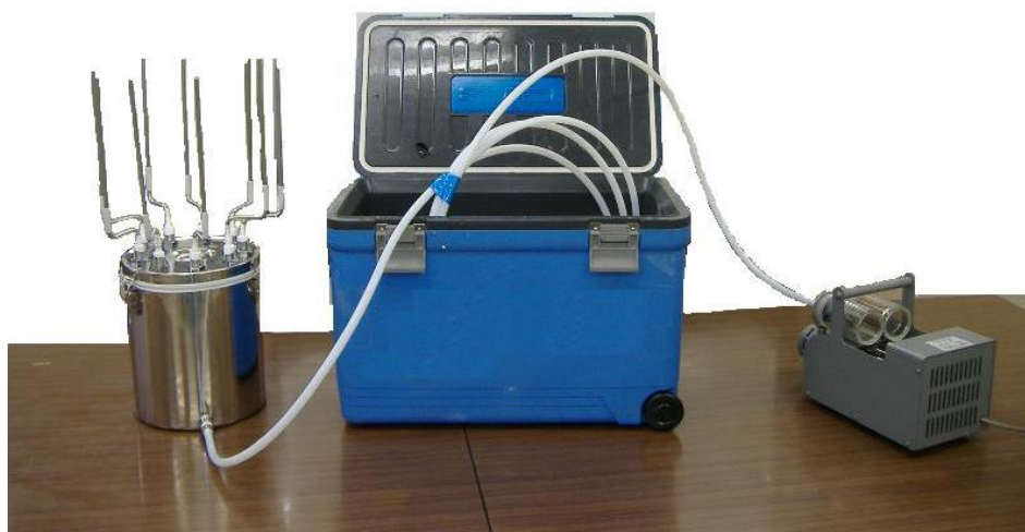
水冷方式の例（ポリふっ化樹脂製チューブ約 5m） （必要に応じて凝縮水トラップを設置する：P15 参照）
