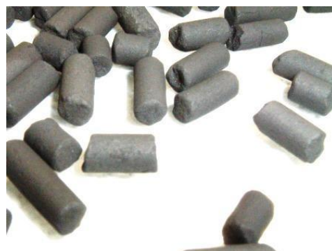
成型炭の一例 円柱状に成型された活性炭。
