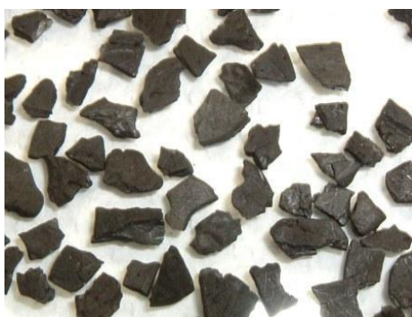
破碎炭の一例。 ヤシガラから製造された活性炭
