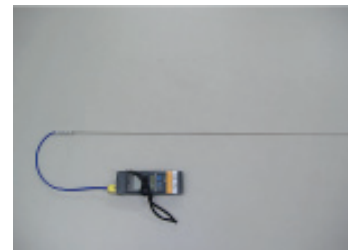
写真 2-8 排ガス温度計の例
