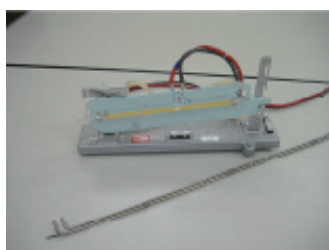
写真 2-6 流速測定器 (傾斜マノメーターとピトー管)
