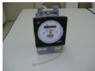
写真 2-10 乾式ガスメーターの例
