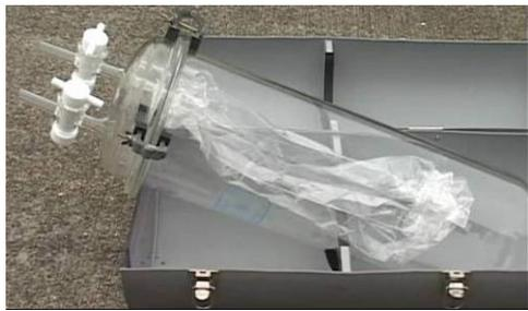
◇2つのコックとも開いていることを確認したのち、試料採取袋のついていないコック（コック B とする）からポンプを用いて試料採取袋がほぼ満杯になるまで脱気し、コック B を閉じる。
