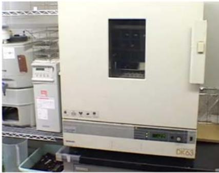
◇注射器は乾燥機に入れて乾燥させる。
