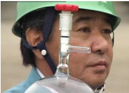
◇試料採取口にシリコン栓を挿したまま、コックを開ける。
